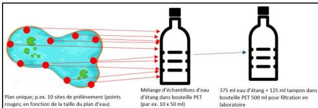
Figure 7 : Prélèvements d'échantillons dans un plan unique
